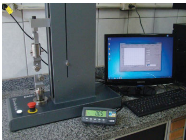
Fig. 2 Aparato experimental dos ensaios de tração: máquina de ensaios mecânicos BME 10 kN, célula de carga de 50 kgf e garras de fixação.
