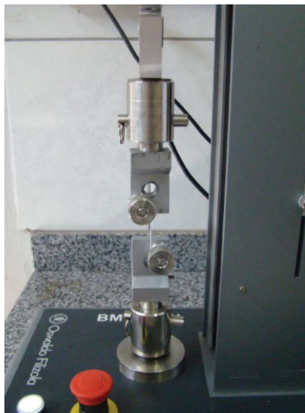
Fig. 3 Garra metálica própria para o ensaio de fios com a manutenção do comprimento inicial de 5 cm.
