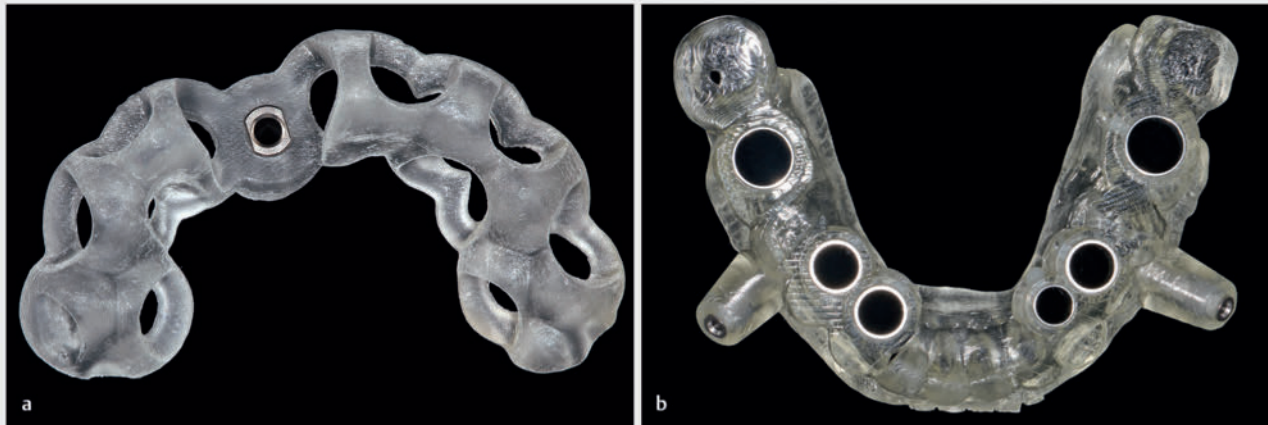
► Abb. 24 Bohrschablonen, die mit einem 3-D-Drucker nach dem Polyjet-Verfahren hergestellt wurden.
