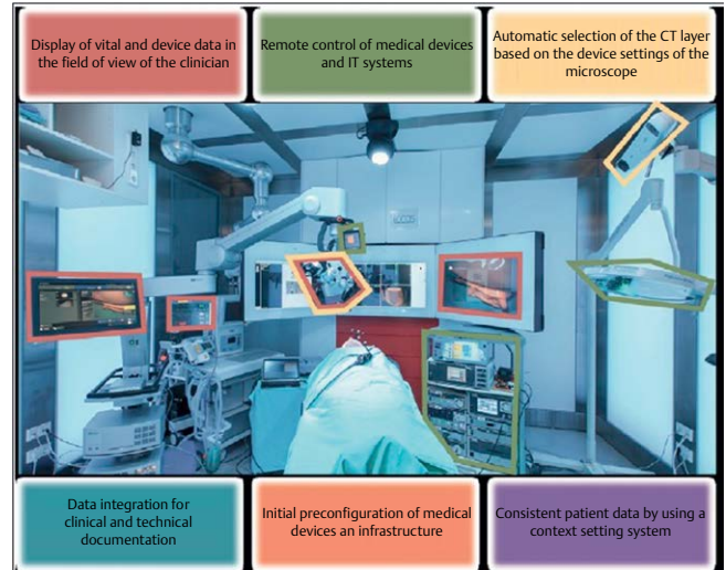
► Abb. 18 Ergonomischer Versuchsaufbau der technischen Komponenten des OR.NET im ICCAS für die HNO-chirurgischen Anwendungsfälle. [Bildquelle: ICCAS Leipzig [3, 80], modifiziert].
