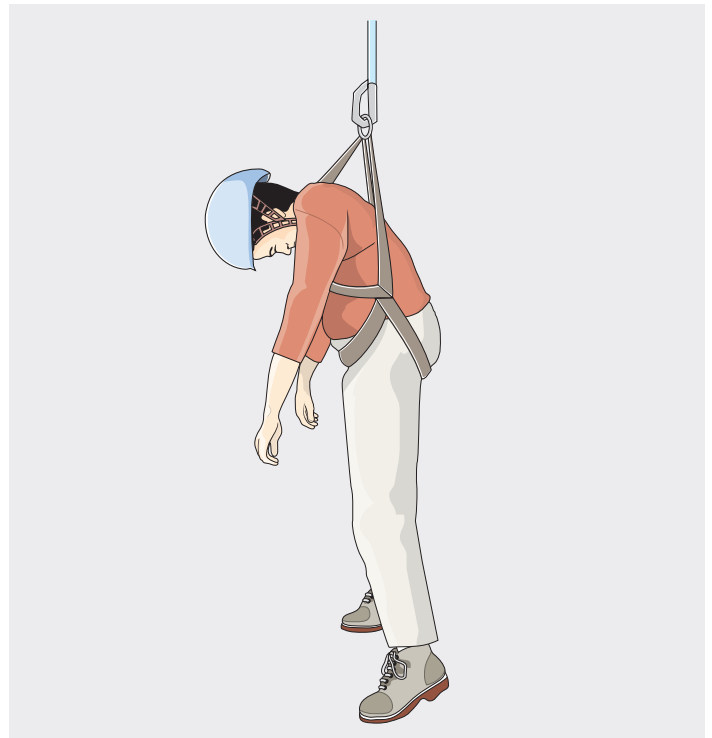
► Abb. 3 Gurtsysteme mit Anseilpunkt am Rücken führen zu einer sehr vertikalen Hänge- und Körperposition und damit zu einer erschwerten Selbststretzung zu einer möglichen Kompression der Femoralgefäße durch das eigene Körpergewicht und – bei Bewusstlosigkeit – zu einer Flexion des Kopfes mit erhöhtem Risiko der Atemwegsverlegung.
