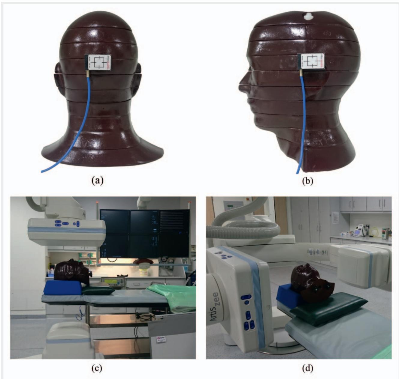
► **Abb. 1** Aufbau zur Messung der Konversionsfaktoren am Kopfphantom. Platzierung des Silizium-Halbleiterdetektors bei **a** der Untertisch- bzw. p.-a. Projektion und **b** der Übertisch- bzw. lateralen Projektion. Lage des Kopfphantoms relativ zum C-Bogen bei **c** der Untertisch- bzw. p.-a. Projektion und **d** der Übertisch- bzw. lateralen Projektion.
