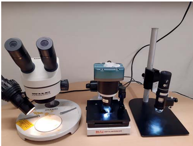
► Abb. 1 Alltagstaugliche preisgünstige Kapillarmikroskope 1980 (links), 2010 (Mitte) und 2020 (rechts). Die Geräte werden kleiner, die Handlichkeit wird besser, digitale Archivierung wird möglich, in der neuesten Generation kabellos und auf dem Smartphone speicherbar.
