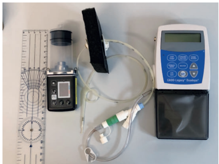
► Abb. 2 Links die Crono LECIG (CE 0476) für die Infusion in das Jejunum von Levodopa/Entacapon/Carbidopa intestinales Gel (LECIG) und rechts die CADD-Legacy 1400-Pumpe (CE 0473) für die Infusion in das Jejunum von Levodopa/Carbidopa intestinales GEL (LCIG) mit der äußeren Transabdominalsonde (gastraler Schenkel) und einer feinlumigeren inneren Applikationssonde (jejunaler Schenkel) für die PEG (schwarzes Schaumstoffstück soll die Bauchwand darstellen). Quelle: © A. Ceballos-Baumann, München
