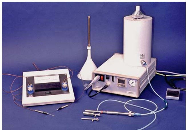
Abb. 2 In den 90er-Jahren in Dresden entwickeltes leistungsfähiges Kryogerät mit N_2 -durchströmten Kältesonden und intraläsionalen Thermoelementen. Das Gerät kam nicht in die Serienproduktion.
