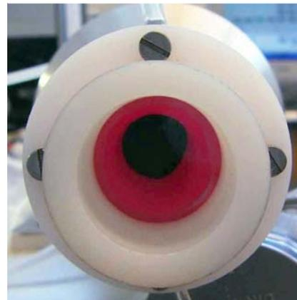
**Abb. 6** Pneumatisch gesteuerter Verschlusskörper im geöffneten Zustand.
