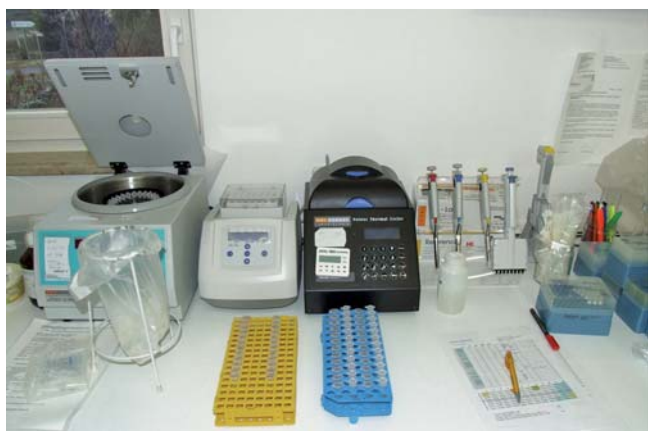
Abb. 4 PCR-Arbeitsplatz zum Nachweis von Dermatophyten-DNS aus Hautschuppen und Nagelspänen: Zentrifuge, Thermoschüttler und Thermocycler als essenzielle Minimalausstattung.
