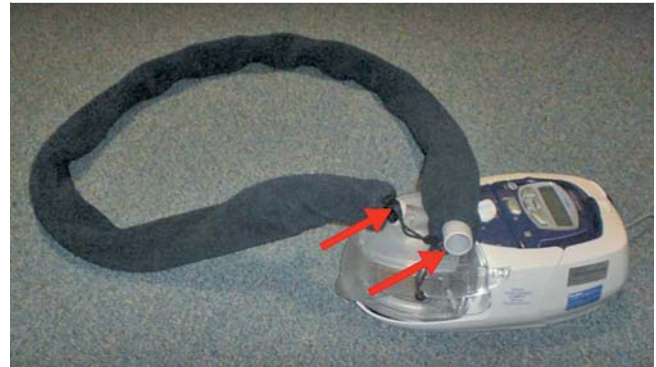
Abb. 2 Messung von Temperatur und Luftfeuchtigkeit am Befeuchter und am Schlauchende. Die Messung erfolgte unter Schlauchisolation mit einer Schlauchhülle. Temperatur des Raumes 16,4 °C.
