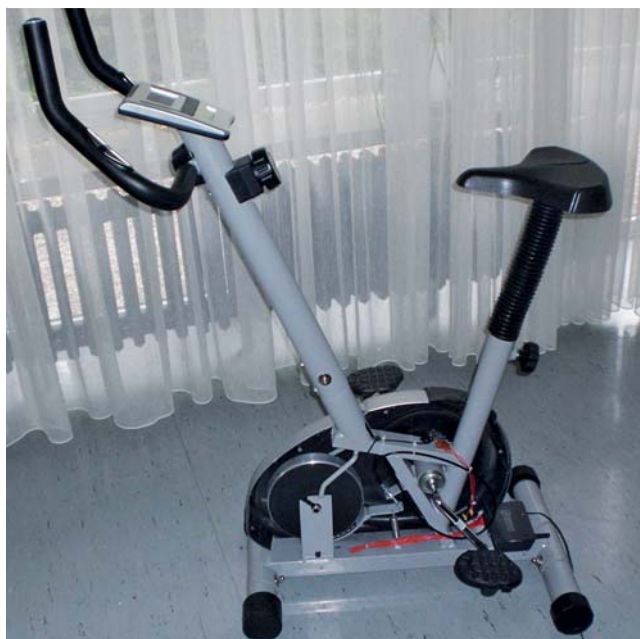
Abb. 2 Fahrradergometer nach Entfernung der Abdeckung. Man sieht zwei Schwungscheiben. An der hinteren Scheibe befindet sich ein Magnet, der in einem Magnetschalter bei Pedalbewegungen einen Impuls auslöst. Am hinteren Ende befindet sich ein GSM-Modul (Global System for Mobile Communication) mit eingebautem Microcontroller, in dem die Zeitdauer des Trainings automatisch erfasst wird. Etwa 30 sec nach Beendigung des Trainings wird die Trainingsdauer über die Antenne automatisch verschickt. Die Stromversorgung erfolgt über Trafo und Netzkabel.
