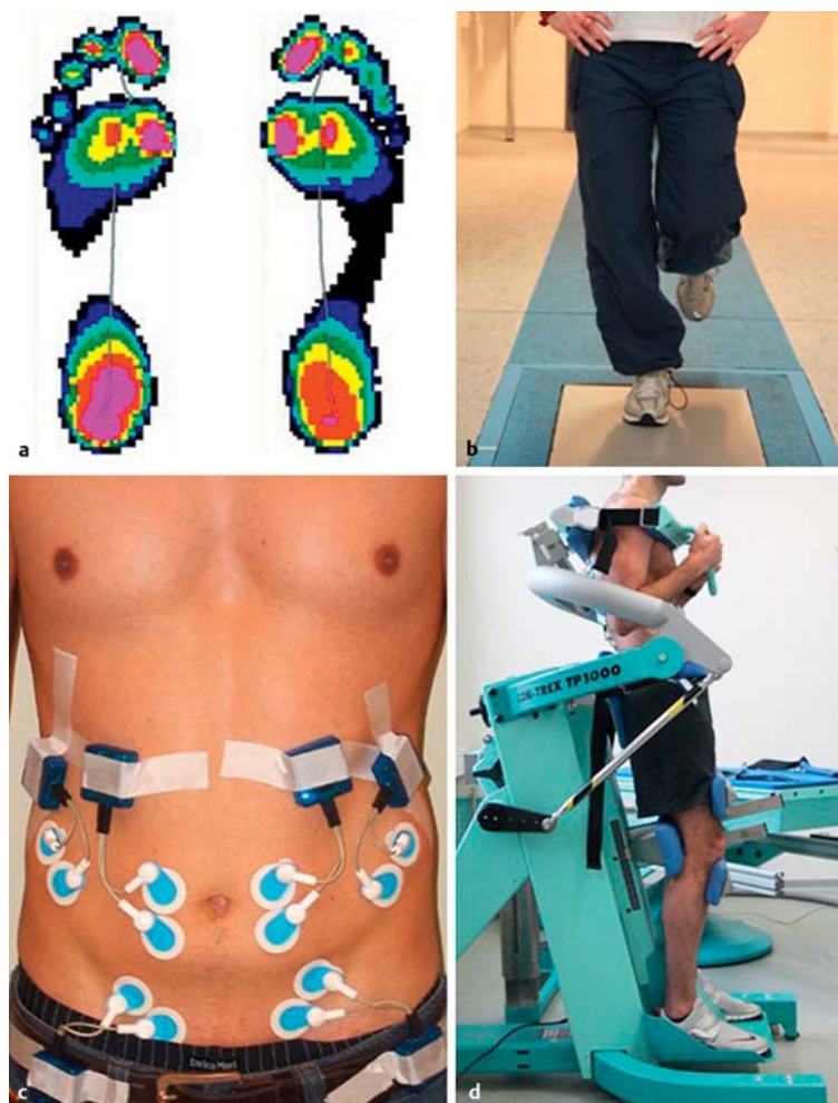
Abb. 6 ■ Biomechanische Mess- und Analysemethoden in der Sportorthopädie. a Ergebnis einer plantaren Druckverteilungsmessung. b Messung der Bodenreaktionskraft im Einbeinstand. c Telemetrische Messung der muskulären Aktivität (Oberflächen-EMG) am Rumpf. d Isokinetische Rumpfkraftmessung (Flexion/Extension).
