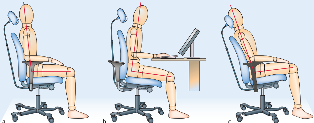
Abb. 1 Optimales Sitzen: Der Bürostuhl muss sich den verschiedenen Sitzpositionen flexibel anpassen: a) mittlere Position, b) Position für das Arbeiten in vorgeneigter Position, c) rückgeneigte Position
