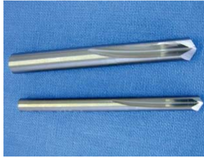
Abb. 8 Carbide-Bohrer in 2 Größen. In der Industrie haben sich die Carbide-Bohrer schon lange bewährt. Es gibt sie dort in einer großen Vielfalt. Für uns stehen mehrere passende Größen zur Verfügung.
