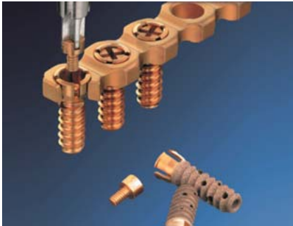
Abb. 10 THORP-Prinzip (1990). Die Wirbelsäulenoperateure (s.o. HWS-Platte) und die gesichtschirurgischen Operateure waren in dieser Zeit wohl etwas konsequenter. Für den mund-kiefer-gesichtschirurgischen Bereich gab und gibt es eine lange winkelstabile Platte, die nach dem ähnlichen Prinzip arbeitet. Ein viergeteilter Schraubenkopf wird nach endgültiger Positionierung durch eine zentrale Madenschraube nach außen gegen die Wand der Platte expandiert, sodass eine stabile Blockade entsteht.
