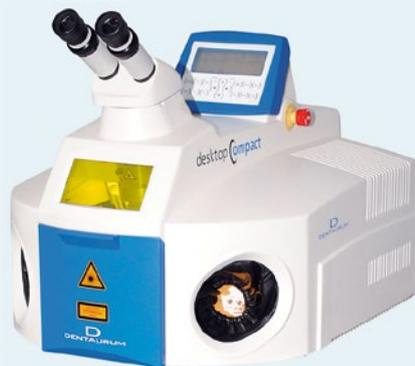
kompakt und sehr anwenderfreundlich. Feinste Schweißungen, wie z.B. bei sehr dünnen Drähten, bis hin zu massiven Verbindungen wie bei Suprakonstruktionen oder Reparaturen aller Art, sind schnell
