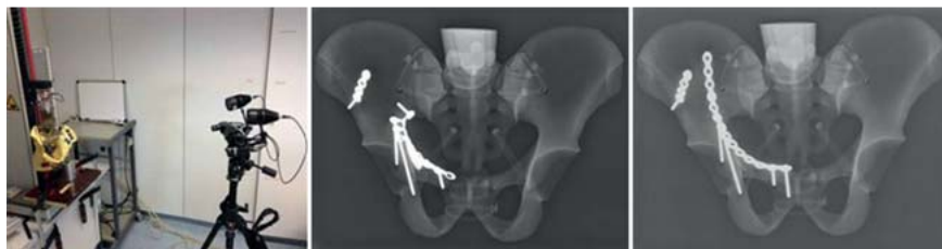
Abb. 4 Versuchsanordnung: Bild links: die Prüfmaschine mit eingespanntem Beckenmodell und optischem Messsystem; Bild in der Mitte: Röntgenbild des Beckenmodells mit angebrachter Flügelplatte; Bild rechts: Röntgenbild des Beckenmodells mit angebrachter J-Platte.
