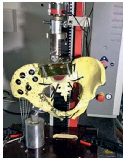
Abb. 3 Beckenmodell bereit für Messzyklus mit der neuen Flügelplatte.
