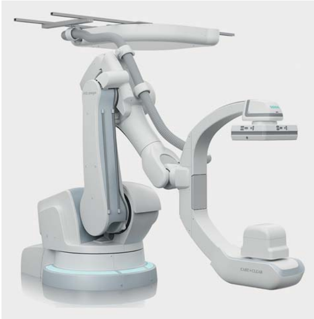
Abb. 4 Flachdetektorbildwandler haben eine verbesserte Arbeitshöhe, da der Bildverstärker deutlich weniger raumfordernd ist als bei herkömmlichen C-Bögen (hier: Artis zeego®, Siemens, Erlangen).
