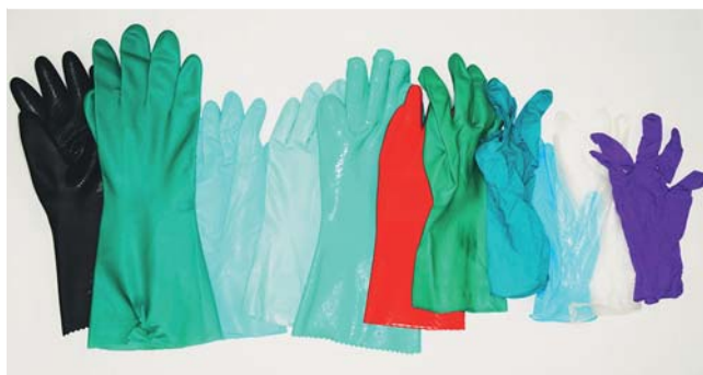
Abb. 4 Verschiedene Chemikalienschutzhandschuhe aus synthetischem Kautschuk und Einweghandschuhe. Von links nach rechts: Chemikalienschutzhandschuh aus Butylkautschuk (schwarz), verschiedene Chemikalienschutzhandschuhe aus Nitrilkautschuk (grün und blau), Chemikalienschutzhandschuh aus Chloroprenkautschuk (rot), Chemikalienschutzhandschuh aus Nitrilkautschuk (grün), Nitrileinweghandschuhe (blau), Vinyleinweghandschuh (weiß/transparent), Nitrileinweghandschuh (violett).
