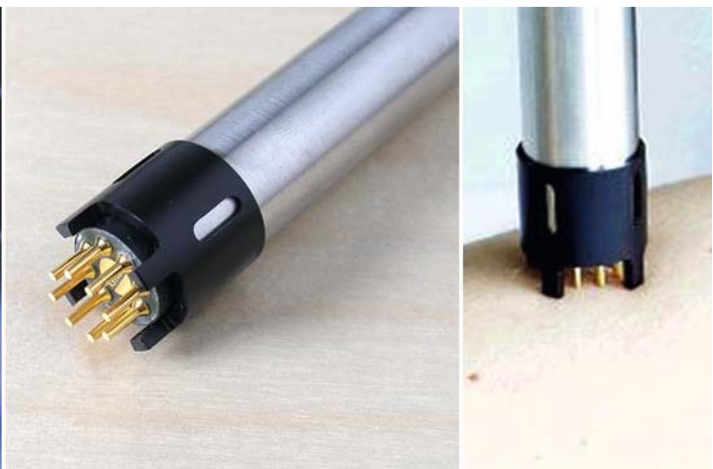
Abb. 2 Quantifizierung der Hautfeuchtigkeit mit der Pin-Sonde (DermaLab®, Cortex Technology) – das spezielle Design mit acht Pins ermöglicht die Messung der Hautleitfähigkeit selbst bei trockener und behaarter Haut.
