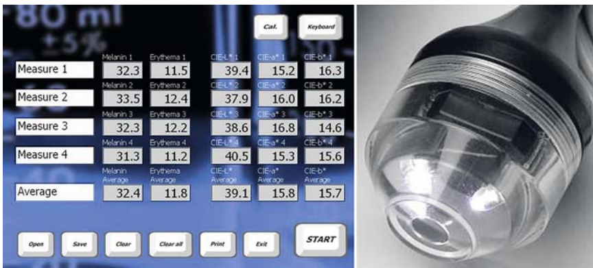
Abb. 7 Messung des objektiven Pigmentierungsgrades nach dem Prinzip der Reflektions-Spektroskopie (DermaLab® Combo, Cortex Technology) – Farbspektren E/M und CIELAB.
