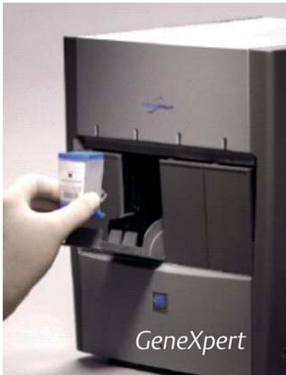
Abb. 1 Das Cepheid GeneXpert System mit einer Xpert MTB/RIF-Kartusche zur Detektion von M. tuberculosis -Komplex Bakterien und der Rifampicin-Resistenz.
