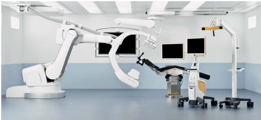
Abb. 21 Die Integration des Artis zeego in den Operationstisch und das Navigationssystem ermöglichen einen optimierten und beschleunigten Arbeitsablauf mit automatisierter Registrierung beim Navigationssystem.
