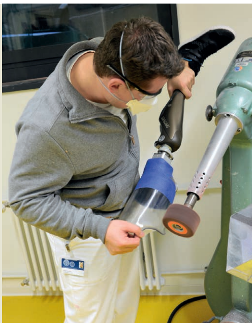
Der Orthopädietechniker Daniel Kornmann kürzt die Ränder des Prothesenschafts und rundet sie ab.
