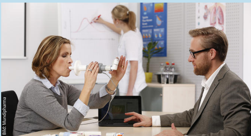
Der Inhalations-Coach misst verschiedene Parameter des Inhalationsmanövers wie Atemfluss, Flussbeschleunigung, Inhalationsdauer und inspiratorisches Volumen, deckt Koordinationsfehler auf und visualisiert die Ergebnisse.
