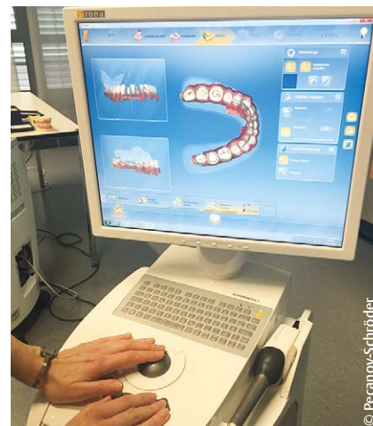
Scannen und Konstruieren mit der mobilen Cartvariante CEREC AC mit Omnicam.
