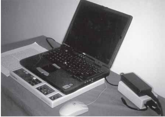
Figura 2 – Equipamento para estimulação e registro intra-operatório de potencial de ação do nervo através da lesão, modelo Keypoint® portátil da Medtronic Functional Diagnostics®.
