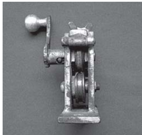
Figura 1b – Aparelho caseiro usado para fabricação dos cliques.
