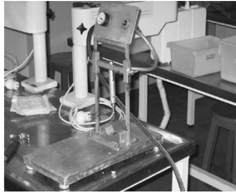
Figura 1 – Modelo de dispositivo de impacto cortical controlado, conectado ao compressor de ar.
