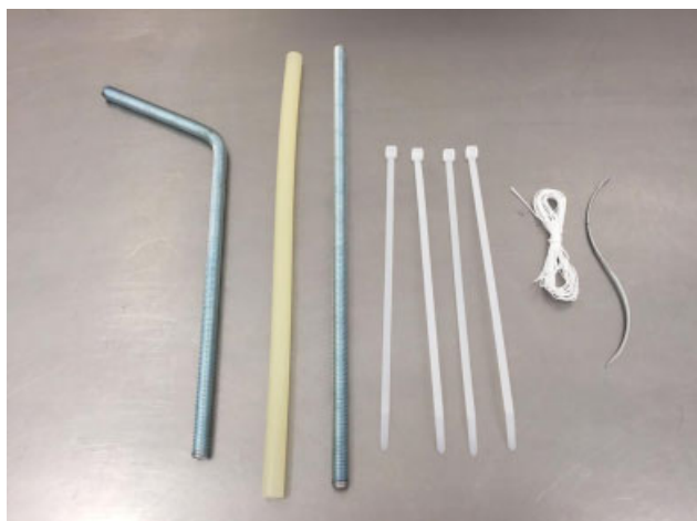
Fig. 1 Vergalhão metálico, tubo de silicone, abraçadeira de Nylon, fio de sutura e agulha de sutura em "S".
