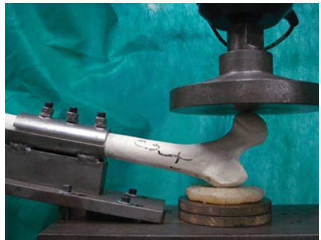
Fig. 2 Osso sintético antes da realização do teste mecânico.
