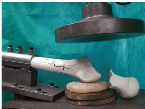
Fig. 4 Modelo experimental após ocorrência de fratura.
