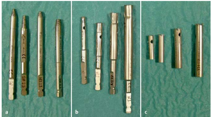
Abb. 10 a bis c Konische Extraktionsschrauben mit Linksgewinde (a), konische Extraktionsbolzen mit Linksgewinde (b), Hohlfräsen (c).
