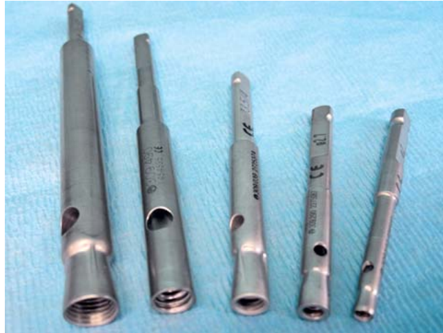
Abb. 6 Linksdrehender Extraktionsbolzen: Dieser funktioniert wie die Extraktionsschraube, nur von außen. Das heißt, das Gewinde des Extraktionsbolzens muss sich linkswendelnd in das Außengewinde oder den abgeschliffenen Schaft des zu entfernenden Schraubenschafts eingraben. Wenn das Drehmoment des Extraktionsbolzens gegenüber der Schraube größer wird als das notwendige Drehmoment zum endgültigen Ausdrehen des Schaftes, kommt die Schraube rückwärts gedreht heraus.
