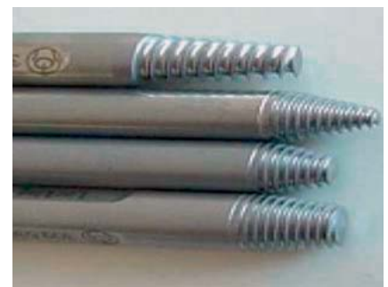
Abb. 7 Erstes Hilfsmittel bei zerstörtem Schraubenkopf sind linksschneidende Extraktionsschrauben, die in den Schraubenkopf eingedreht werden [2].
