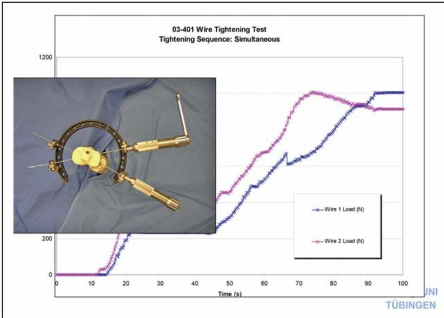
dem Spannen des 1. Drahtes dieser mit einem provisorischen Halter ohne Spannmechanismus gehalten werden. Dieser hält den Draht so lange, bis der 2. Draht gespannt ist. So können beide Drähte sequenziell auf gleiche Spannung gebracht werden (Abb.).
