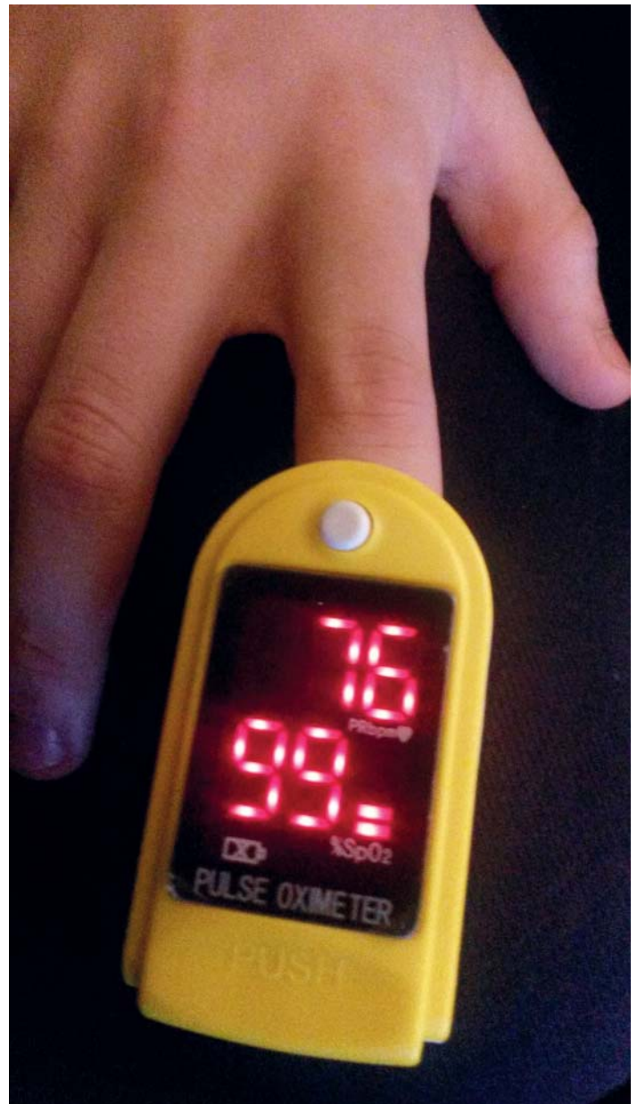
► Abb. 1 Normale Pulsoxymeter können eine CO-Vergiftung nicht erkennen und zeigen fälschlicherweise normale Messwerte an.
