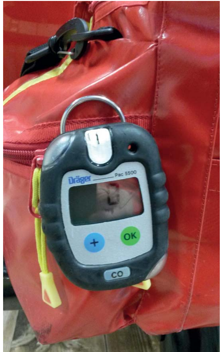
► Abb. 4 CO-Warngerät für Rettungsdienst und Feuerwehr. (Das Warngerät ist hier jedoch ungünstig positioniert. Siehe Details zur Positionierung etc. im Text).
