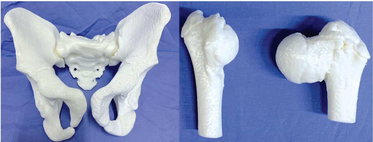
**Fig. 5** Pelve e regiões proximais dos fêmures de paciente masculino, 11 anos, portador de deformidades ósseas complexas, impressas por meio da tecnologia de manufatura aditiva a partir do exame de tomografia computadorizada pré-operatória. Imagem obtida pelos autores.
