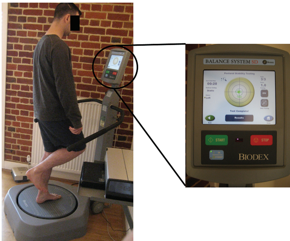
Fig. 4 Teste de estabilidade postural com apoio unipodal usando o Sistema Biodex Balance SD.
