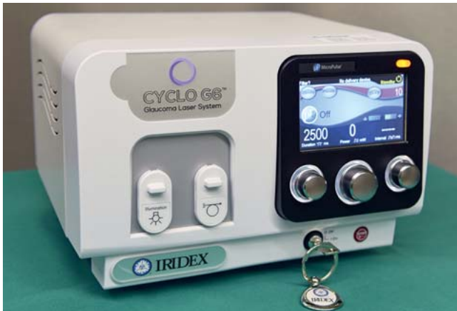
► Abb. 2 Cyclo G6 Glaucoma Laser System der Firma Iridex für die Zyklphotokoagulation. Das Gerät kann sowohl für die transsklerale als auch für die Mikropulszyklphotokoagulation verwendet werden. Neben einem Ausgang für Laserenergie gibt es zusätzlich einen Kaltlichtleiter, der prinzipiell z. B. für die Applikation mit Diaphanoskopie genutzt werden kann.
