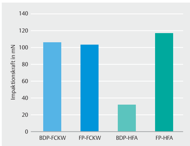
► Abb. 3 Unterschiede der Aufprallkraft bei verschiedenen Dosieraerosolen mit unterschiedlichen Treibgasen (nach [10]).
