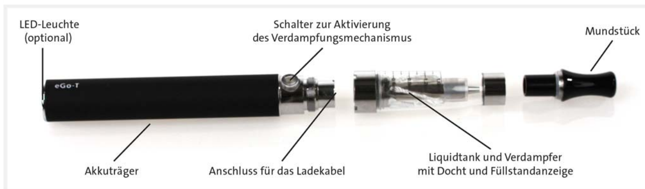
► Abb. 1 Grundaufbau einer E-Zigarette: nachfüllbares und wieder aufladbares Produkt. Quelle: Deutsches Krebsforschungszentrum.
