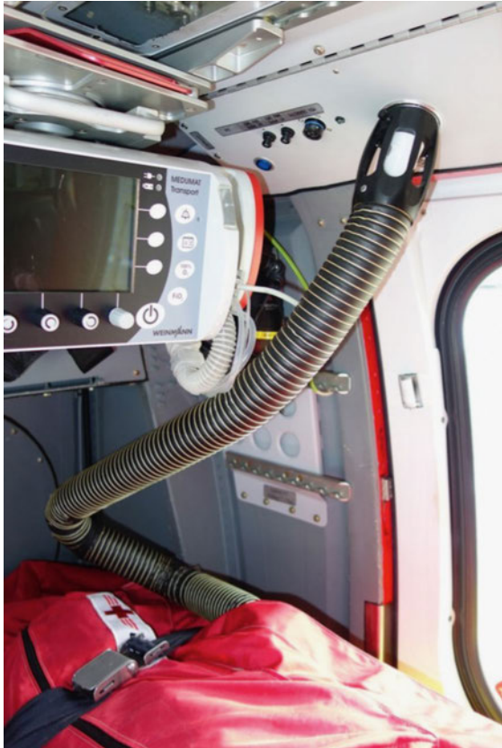
► Abb. 4 Effiziente Warmluftabgabe aus der Kabinenheizung direkt in den Bergesack.
