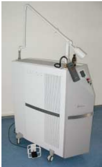
Abb. 1 Excimer-Laser Talos®: 115 kg, Höhe 125 cm, Tiefe 113 cm, Breite 44 cm; Spiegelgelenkarm, Dosimeter rechts vorne am Laser, Mineralöl-Flasche auf und Fußschalter vor dem Gerät.
