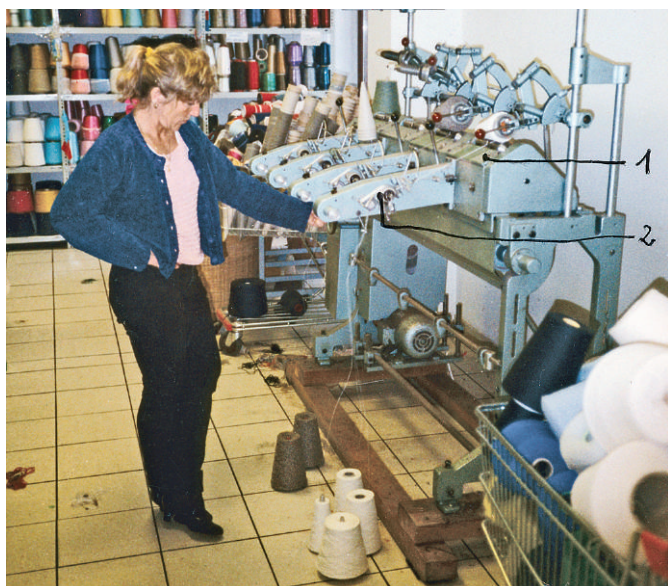
Abb. 1 Umspulmaschine für Wollgarne. (1) zeigt die Kante, in die sich die Nut einfräste, (2) die Umlenkrolle, an der das Garn gespannt wird.
