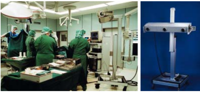
Abb. 2 Infrarotkamera und Aufbau im OP.
