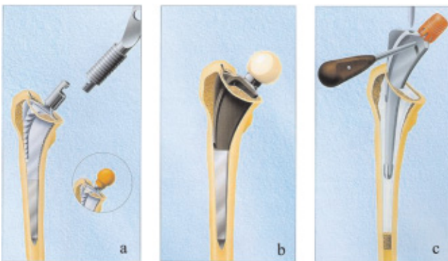
Abb. 5 (a) Vorbereitung des Schaftlagers mit dem B-Profilier (Knochen wird erhalten und verdichtet, mit B-Profilier ist Probereposition möglich), (b) im Schaftlager kann ein Bi-Contact®-Schaft zementfrei oder (c) zementiert (mit Centralizer und Markraumsperrung) verankert werden.
