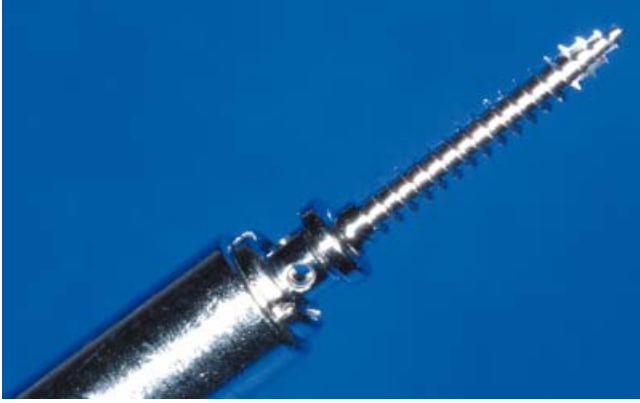
Abb. 3 IMF-Schraube durch die Haltehülse im Schraubendreher fixiert.
