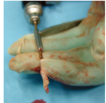
Abb. 5 Bohrmaschinen sind nach der Benutzung zu arretieren, damit es nicht zu ungewolltem Berühren der Schalter kommt und damit zu Verletzungen. In diesem Fall hat der Bohrer den äußeren Handschuh aufgewickelt.
