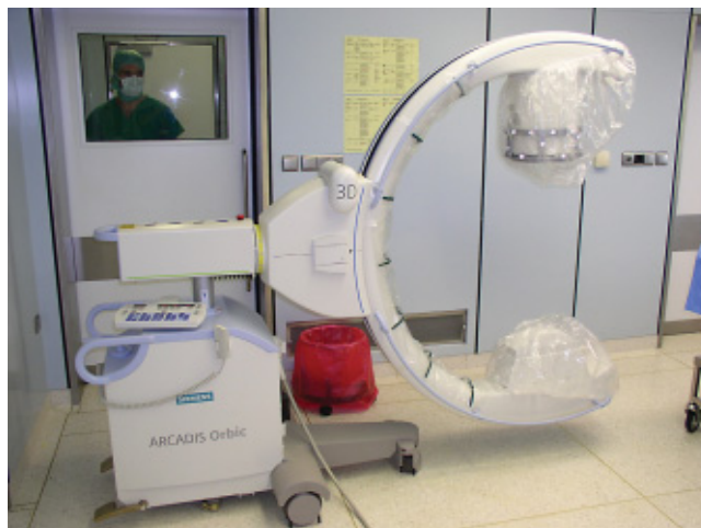
Abb. 2 3D-Bildverstärker mit sterilem Bezug.
